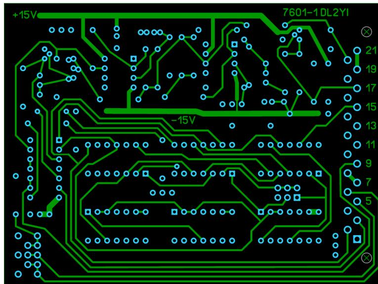
Bild 42a: Druckvorlage Lötseite (ABS) 7601 Rev 1 (75x100 mm, 1:1)
